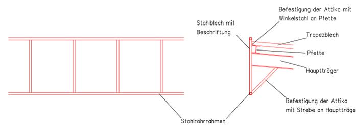
Die Konstruktion der Überdachung ist nur nachrichtlich dargestellt!
